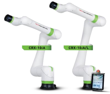
Fig. 125. Fanuc CRX-10iA robot manipülâtörü [10]
